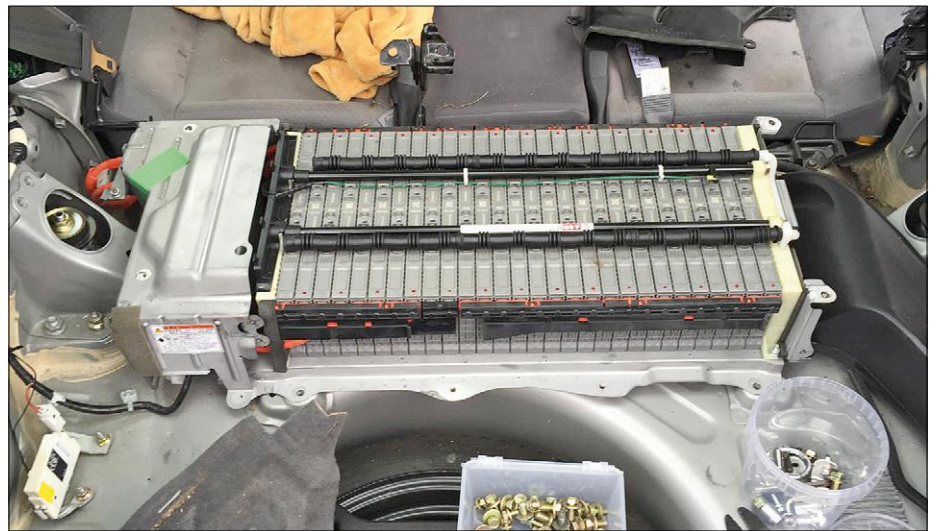
Figuur 2. De geopende hybride-accu van mijn voormalige Prius II: 28 modules met elk zes prismatische NiCd-cellen van Panasonic van elk 1,2 V en 6,5 Ah in serie; dat levert 201,6 V met een energie-inhoud van 1,3 kW bij een gewicht van 39 kg.
